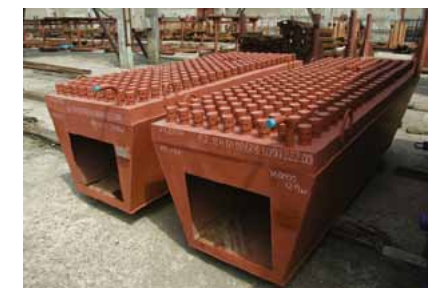
Колпачковая решетка для сжигания топлива в низкотемпературном кипящем слое
