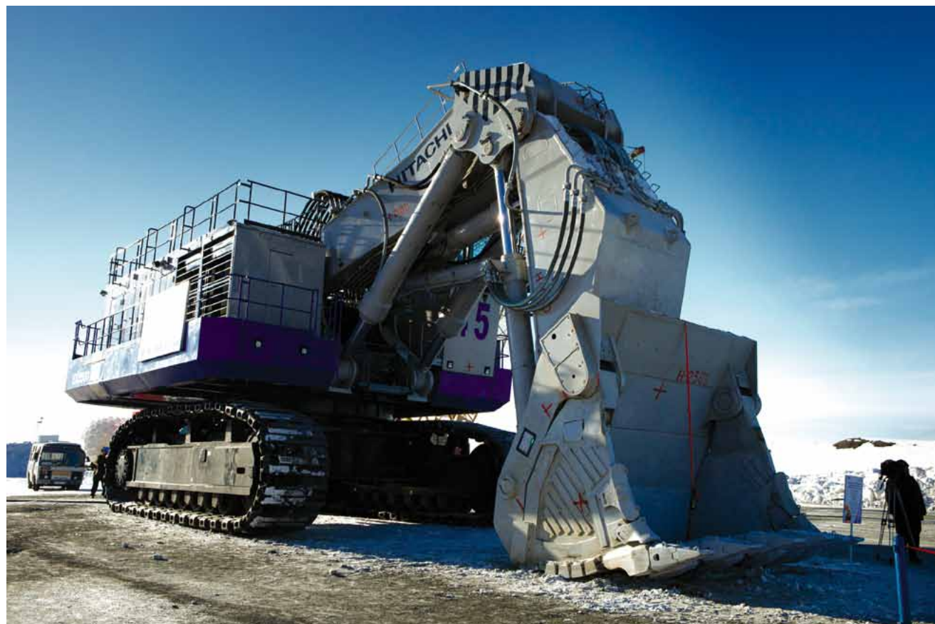
В феврале этого года, на разрезе «Черниговец» запущен первый электрогидравлический экскаватор Hitachi EX-5500 E-6LD с объёмом ковша 27 кубических метров
